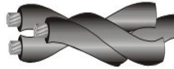
Cáp Triplex: kiểu các một đều bọc (All conductors are insulated)
